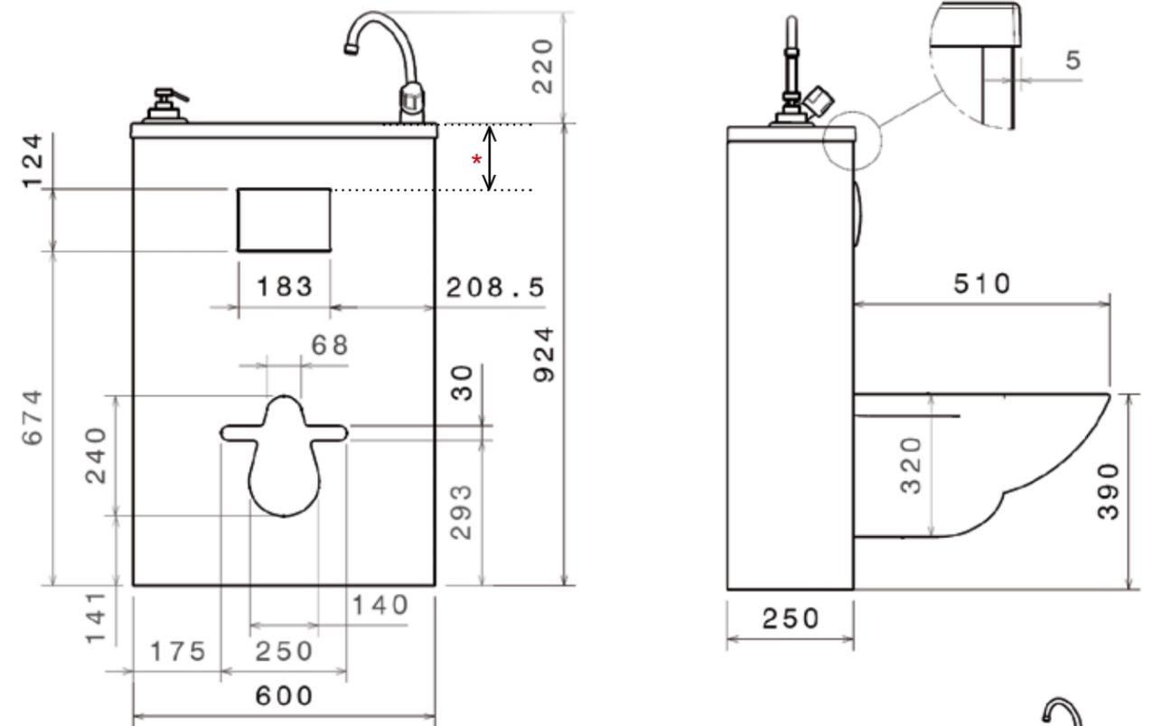
\*Der Abstand, der zwischen der oberen Oberfläche des Unterstühtungsrahmens und der oberen Oberfläche des Beckens berücksichtigt werden muss, beträgt : 11 cm
