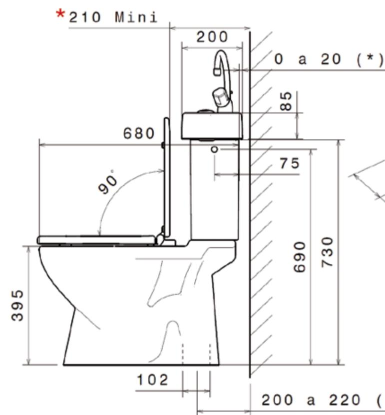
Maßzahlen mit WC mit vertikalem Abfluss
