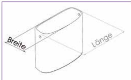
**B- Halterung des Toilettensitzes:** Messen Sie den Abstand zwischen Mauer und Toilettensitz, der senkrecht aufgeklappt worden ist: mindestens 210 mm (\* siehe Plan).
