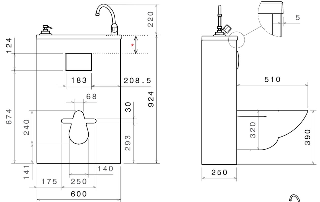
\*Distance à respecter entre la surface supérieure du bâti-support et la surface supérieure de la vasque : 11cm
